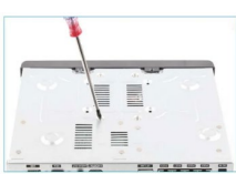
3. Însurubați HDD-ul până la capăt
